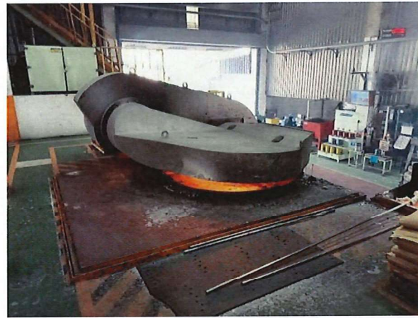
ภาพที่ 10 เตาหลอมแบบเหนียวนำไฟฟ้า
