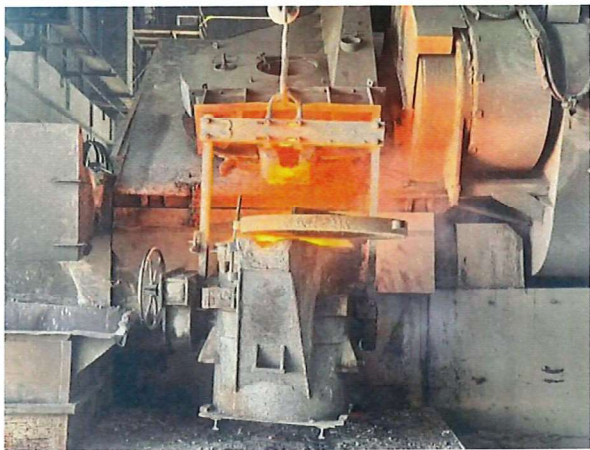
ภาพที่ 7 ระบบรวบรวมฝุ่น (ขั้นตอนเติมแมกนีเซียม)
